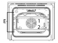
Im Garraum befinden sich Seitengitter mit mehreren Ebenen (E) zum Einschieben des Zubehörs (1+2) in unter-.
