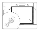
2x Befestigungslöcher befinden sich links und rechts im Gerätetürrahmen.
